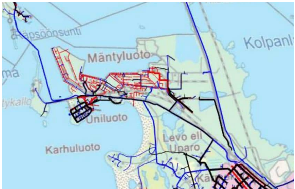
Kuva 12. Ote vesihuollon verkostokartasta. Sinisellä puhdas vesi, punaisella sadevesiviemäri ja mustalla jäte- ja sekavesiviemäri.
